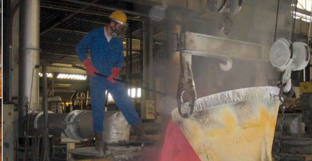
Linksboven: de verweerde werkvloer. Linksonder: op deze foto zijn gaten in overkappingen en muren te zien. Rechts: onder andere bij het gieten ontsnapt veel looddamp de hal in.
